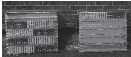
图 1 室外暴露自然老化试验
